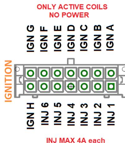
Alternativ können Sie auch unser „Ignition Coils Conversion sheet“ verwenden um die Belegung des Steckers zum Motorkabelbaum beizubehalten.
